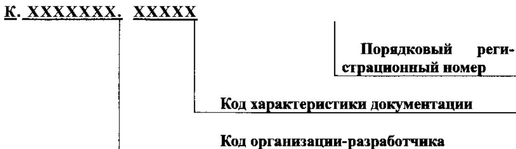
Рис. 7.1 Структура и длина кодового обозначения технологической документации
