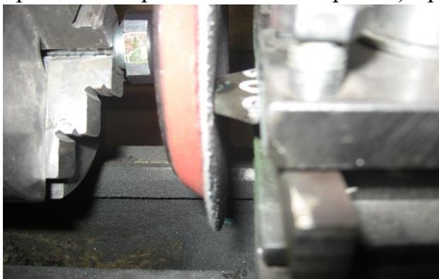
**Рисунок 23 – Процесс мягкой шлифовки образца кругом с зерном Р40**
