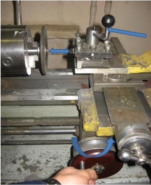
**Рисунок 17 – Подвод подвижной части станка к зачистному кругу**
