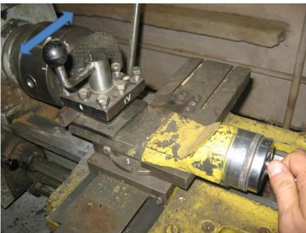
**Рисунок 19 – Плавная регулировка радиального расстояния от образца до круга**
