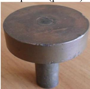
**Рисунок 8 – Электрод с увеличенной контактной поверхностью**
