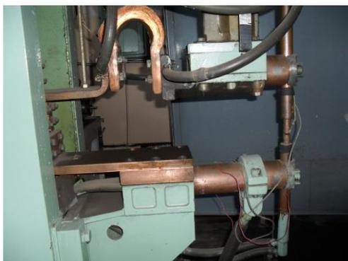
**Рисунок 7 – Машина контактной точечной сварки типа МТ-3201**
