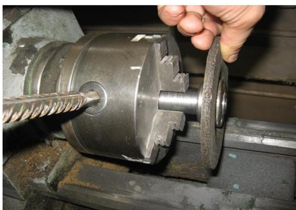
**Рисунок 13 – Установка оправки с кругом в патрон станка**
