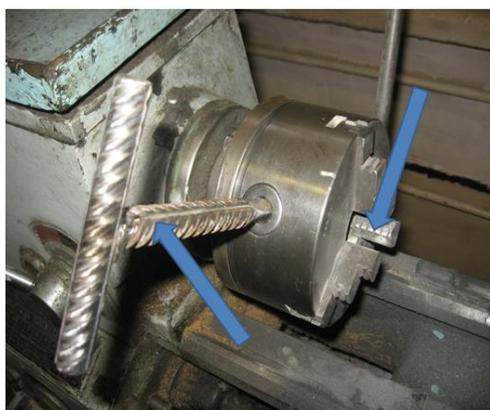
**Рисунок 12 – Ключ для зажатия оправки в патроне**
