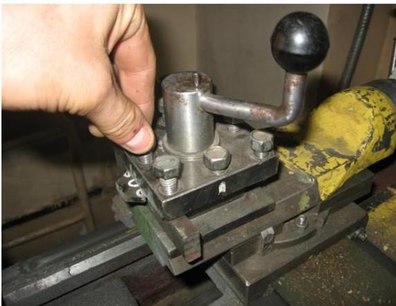
**Рисунок 16 – Зажатие образца винтом**
