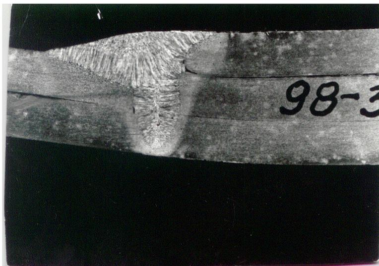
Рисунок 2 – Сварное соединение сварки, полученное при двух дугах
