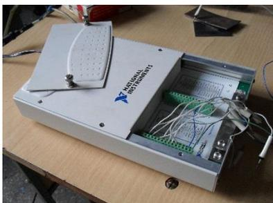
**Рисунок 2 – Устройство сбора данных *NI USB 6251***
