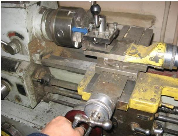
**Рисунок 18 – Плавная регулировка осевого расстояния от образца до круга**
