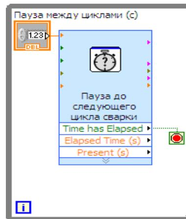
Рисунок 26 – Цикл паузы до готовности программы к следующему циклу сварки
