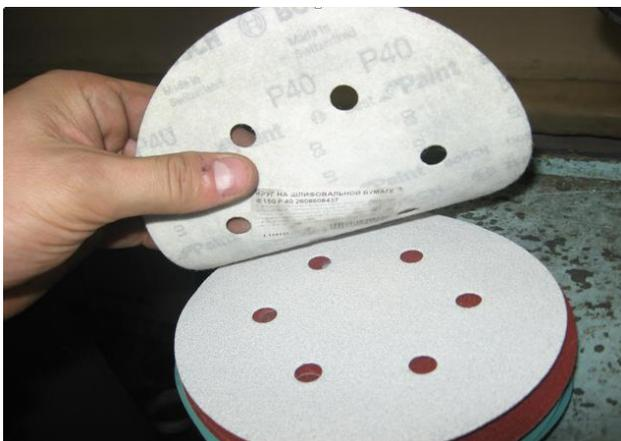
**Рисунок 22 – Мягкий шлифовальный круг крупного зерна**
