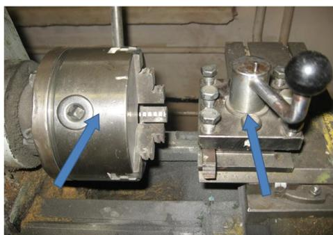
**Рисунок 10 – Патрон токарного станка и захватный механизм**
