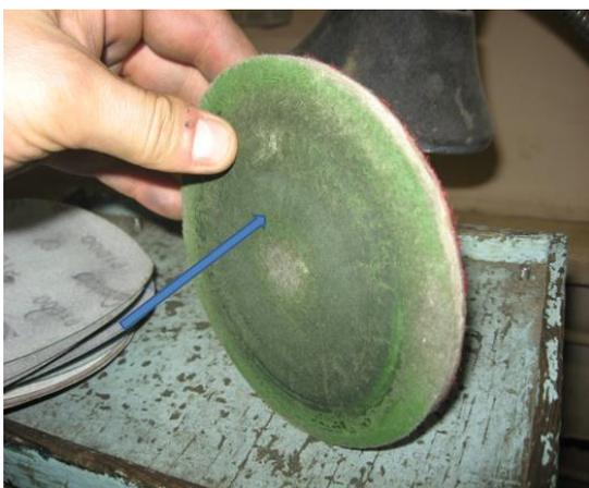
**Рисунок 25 – Войлочный круг для финишной шлифовки образца**
