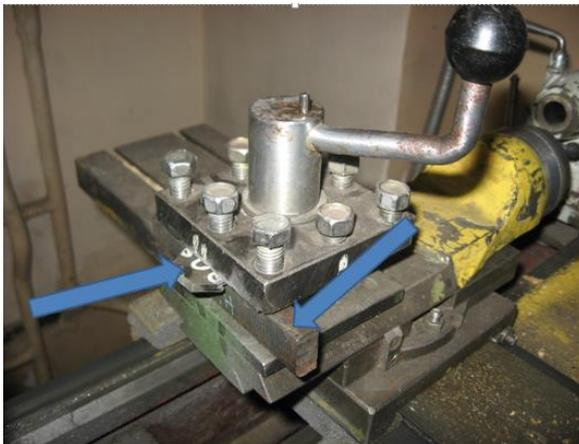
**Рисунок 15 – Фиксация образца на планке в зажимном механизме станка**
