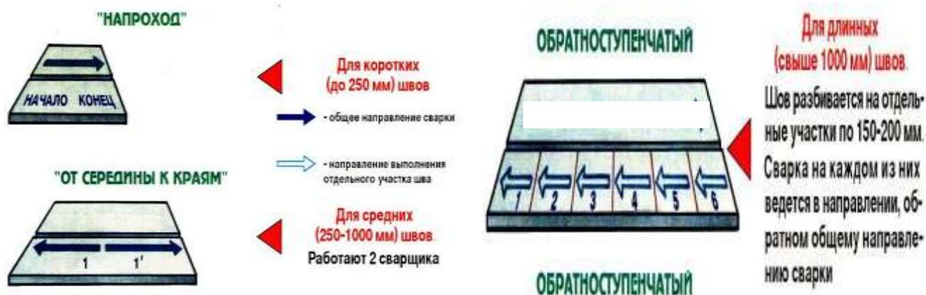
Рисунок 2 – Последовательность выполнения сварных швов
