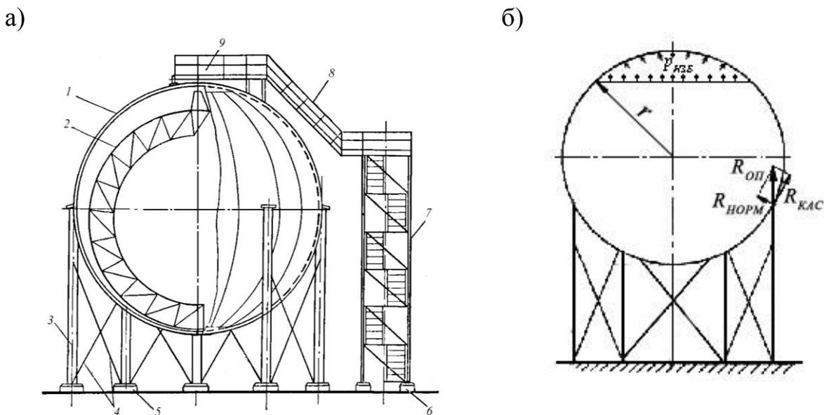
а – общий вид; б – расчетная схема; 1 – оболочка резервуара; 2 – смотровая лестница; 3 – опорная стойка; 4 – диагональные связи; 5 – фундамент стоек; 6 – фундамент шахтной лестницы; 7 – шахтная лестница; 8 – переходная площадка; 9 – площадка обслуживания
