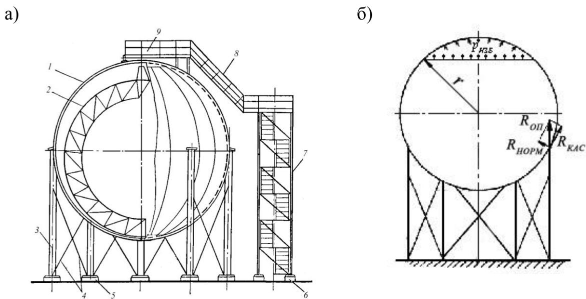
а – общий вид; б – расчетная схема; 1 – оболочка резервуара; 2 – смотровая лестница; 3 – опорная стойка; 4 – диагональные связи; 5 – фундамент стоек; 6 – фундамент шахтной лестницы; 7 – шахтная лестница; 8 – переходная площадка; 9 – площадка обслуживания
