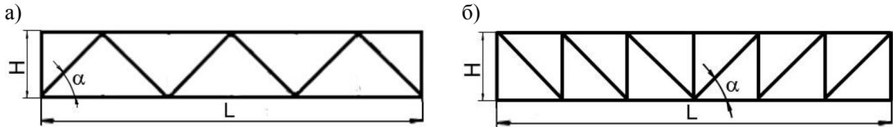
а – ферма с треугольной решеткой; б – ферма с раскосной решеткой; L – длина пролета фермы; H – высота фермы; α – угол наклона раскосов
