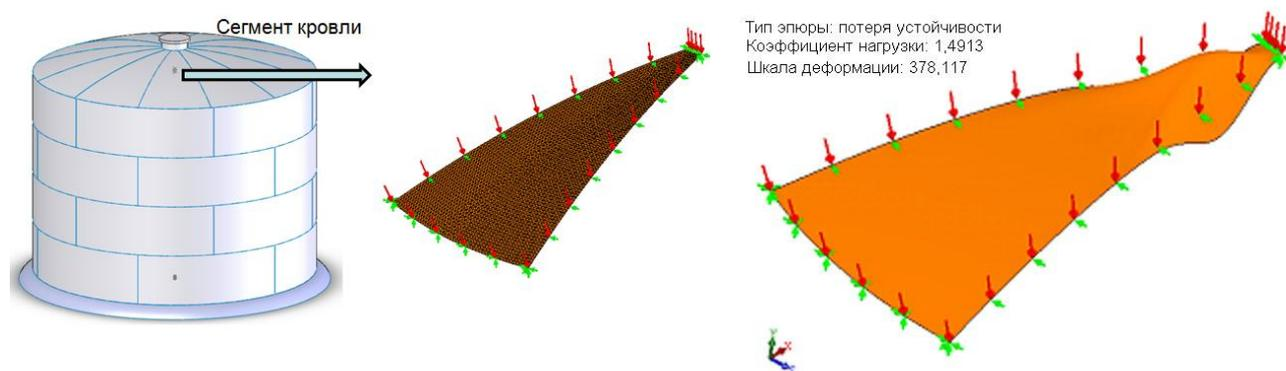
Рисунок 10 – Проверка устойчивости сегмента кровли цилиндрического резервуара
