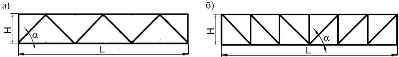
а – ферма с треугольной решеткой; б – ферма с раскосной решеткой; L – длина пролета фермы; H – высота фермы;  $\alpha$  – угол наклона раскосов
