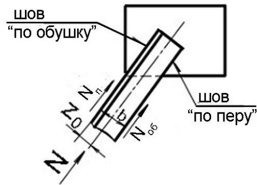
Рисунок 9 – Расчетная схема сварного узла
