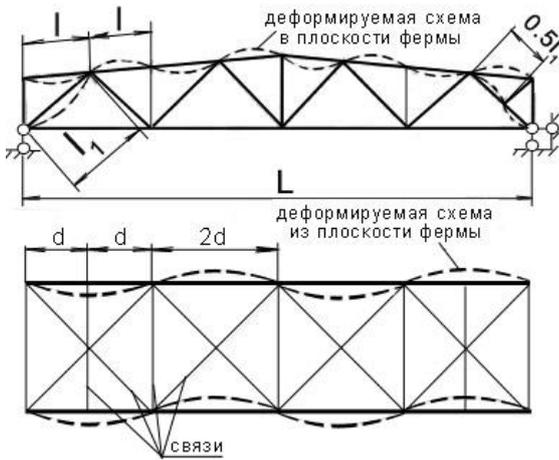
Рисунок 8 – Схема определения расчетных длин элементов фермы
