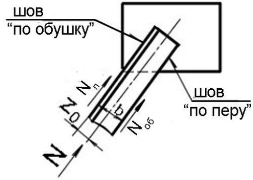
Рисунок 9 – Расчетная схема сварного узла
